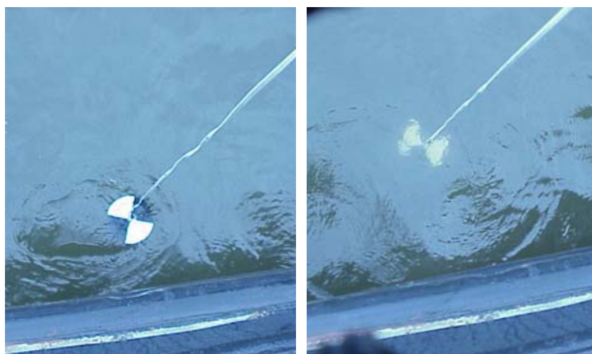
Mynd 2: Rýniskífa ("secchi diskur") látin síga niður í vatn. Gildi rýni er það vatnsdýpi þar sem skífan hverfur sjónum manns.
