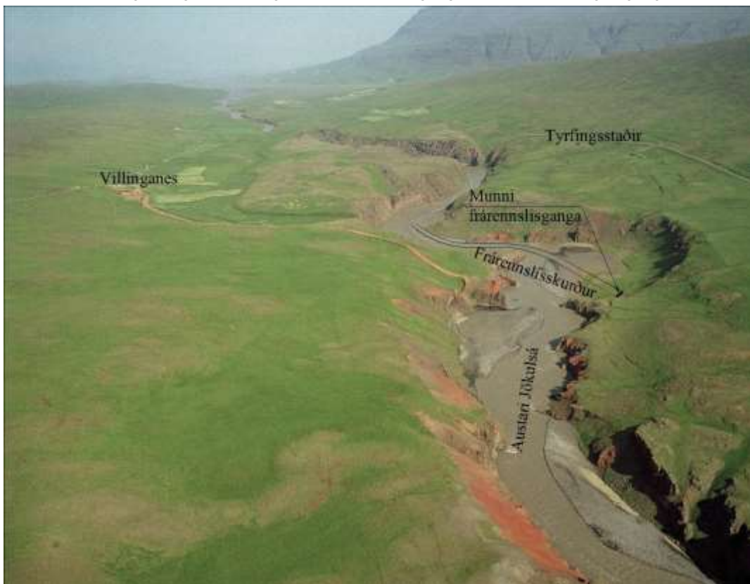
Mynd 8 Ljósmynd af Héraðsvötnum séð til norðurs (Mats Wibe Lund). Villinganes að vestanverðu og eyðibýlið Tyrfingsstaðir austan ár. Frárennslisgöngin munu opnast út í farveginn í bugtinni að austanverðu nálægt miðri mynd.
