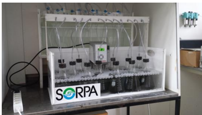
Mynd 5. Tilraunaútbúnaður fyrir metanvinnslu. Tilraun í gangi. Rúmmálmælar eru fyrir aftan gerjunarbúnaðinn.
